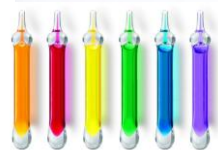
Спринклерные оросители имеют стеклянную термоколбу с температурой срабатывания 57°C, 68°C, 79°C, 93°C, 141°C, 182°C
